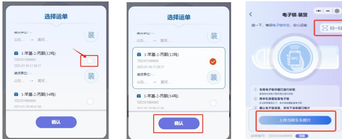
注：若手机不支持NFC功能，可以用右上角扫一扫，对电子锁上二维码进行扫码操作。
