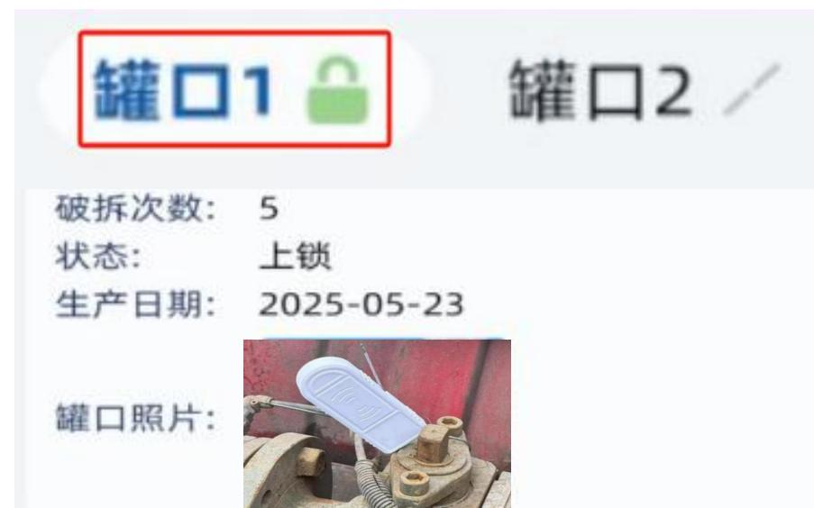
触碰上锁完成后，页面出现提示“已上锁”，点击确定完成当前罐口上锁，系统弹出相机对已上锁罐口进行拍照。拍照完成后确认罐口旁边出现绿色已锁图标，当前罐口完成上锁操作，按照此步骤将所有罐口进行上锁
