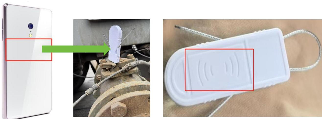
将每个罐口按照以上步骤逐一解锁，解锁完成后使用钳子将钢丝绳剪断，并将钢丝绳从电子锁抽出即可。
