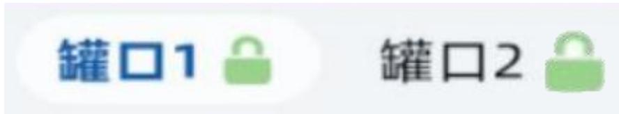
当所有罐口均显示绿色已锁图标后，封闭电子锁步骤完成
